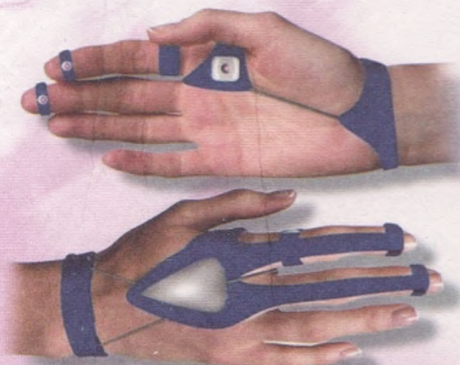
Deanmark AirMouse – оптическая беспроводная мышь, роль левой и правой кнопок выполняют указательный и средний пальцы руки
