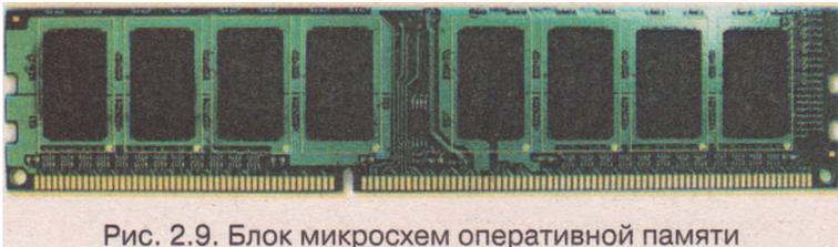
Рис. 2.9. Блок микросхем оперативной памяти
