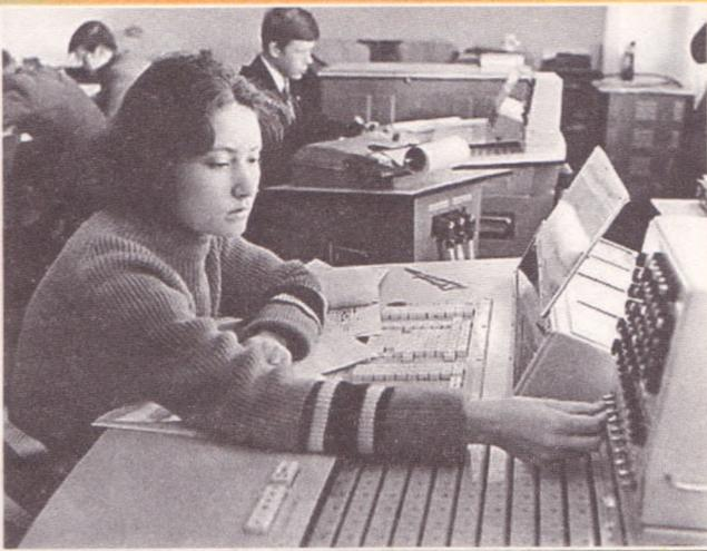
**«Промінь»** – малая электронная вычислительная машина. Отличалась простотой управления, компактностью и экономичностью. Руководитель проекта В.М. Глушков, 1963 г.
