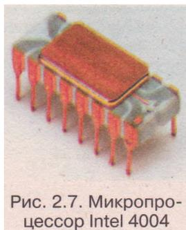
Рис. 2.7. Микропроцессор Intel 4004
