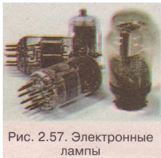
Рис. 2.57. Электронные лампы
