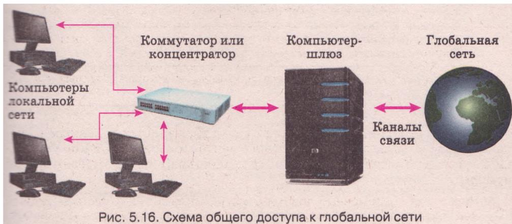
Шлюз должен иметь два канала связи: один для соединения с коммутатором или концентратором и компьютерами локальной сети, а второй для подключения к каналам глобальной сети.
