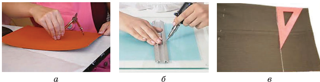
Рис. 57. Разметка заготовок циркулем, линейкой и угольником
