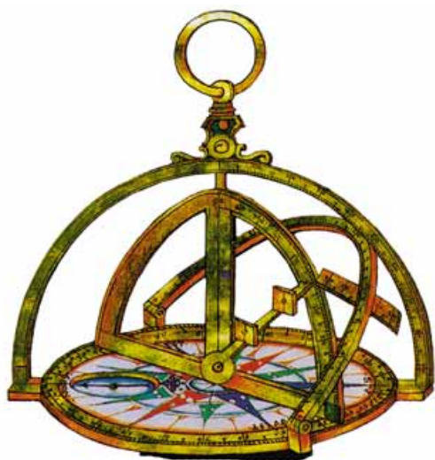
Морская полусфера – прибор, позволявший точно держать выбранный курс корабля
