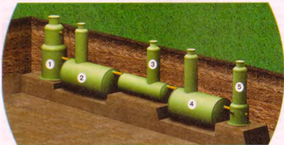
Рис. 6.4. Пример современного очистительного сооружения: 1 – распределительный колодец; 2 – отделитель твердых частиц; 3 – отделитель жиросодержащих веществ; 4 – сорбционный фильтр; 5 – контрольный колодец
