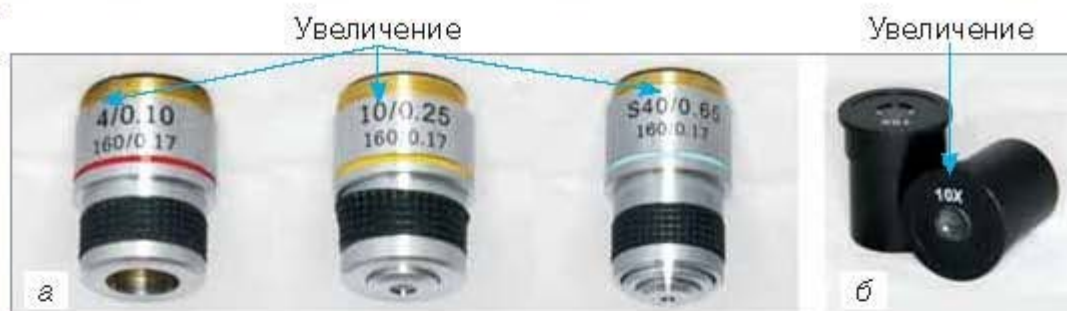
Рис. 7. Объективы (а), окуляр (б) и их маркировка
