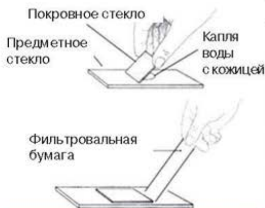
Рис. 23. Изготовление препарата и удаление лишней воды
