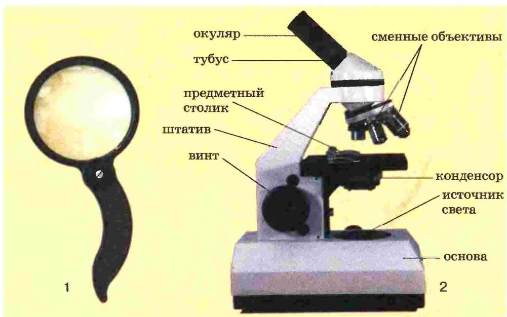
Рис. 18. Увеличительные приборы: лупа (1) и световой микроскоп (2)
