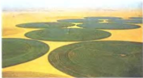
Рис. 65. Орошение полей в Ливийской пустыне. Дождевальное оборудование движется по кругу, а полный оборот делает за 3–4 дня
