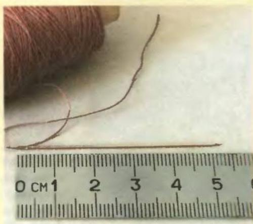
Рис. 1.25. Измерение длины иглы
