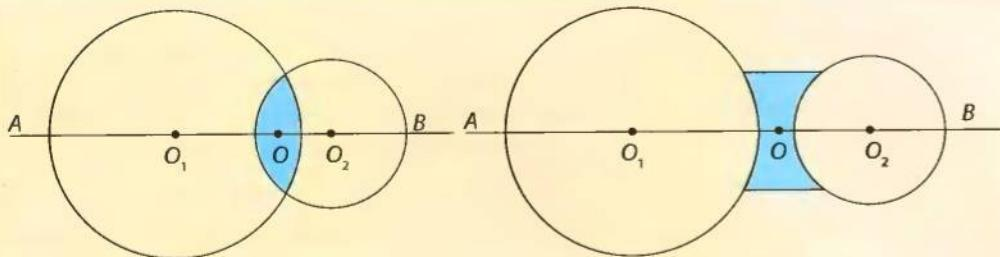
**Рис. 3.55.** Прямая  $AB$ , проходящая через центры  $O_1$  и  $O_2$  сферических поверхностей, ограничивающих линзу, называется главной оптической осью линзы. Точка  $O$  — оптический центр линзы
