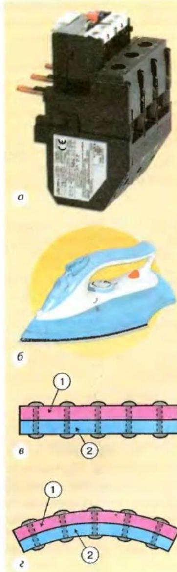
Рис. 2.33. Для изготовления автоматических предохранителей (а), для автоматического включения и выключения нагревательных приборов (б) широко используются биметаллические пластинки (в). Один из металлов при увеличении температуры расширяется намного больше, чем другой, в результате этого пластины изгибаются (г) и электрическая цепь размыкается (или замыкается)
