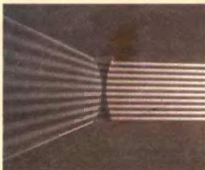
Рис. 3.54. Параллельные лучи, преломляясь в рассеивающей линзе, расходятся (справа — условное изображение рассеивающей линзы)
