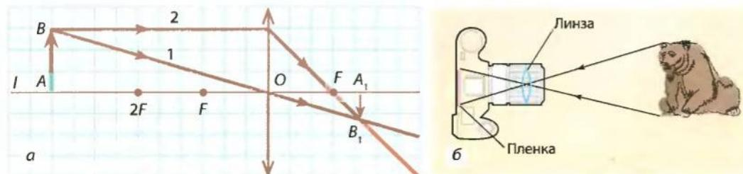
Рис. 3.61. а — построение изображения  $A_1B_1$  предмета в собирающей линзе: предмет  $AB$  расположен за двойным фокусом линзы; б — ход лучей в фотоаппарате
