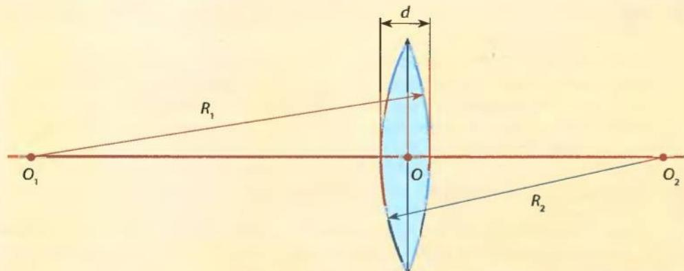
Рис. 3.52. Тонкая сферическая линза:  $d \ll R_1, d \ll R_2$
