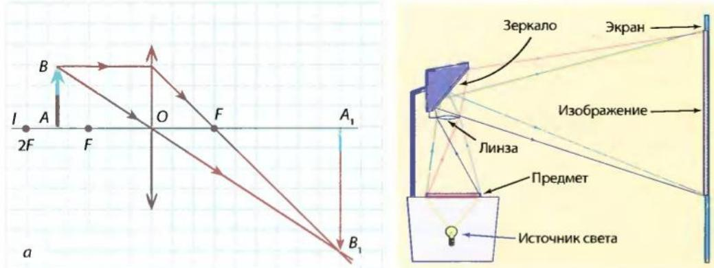
**Рис. 3.62.** а — построение изображения  $A_1B_1$ , предмета в собирающей линзе : предмет  $AB$  расположен между фокусным и двойным фокусным расстояниями; б — ход лучей в проекционном аппарате
