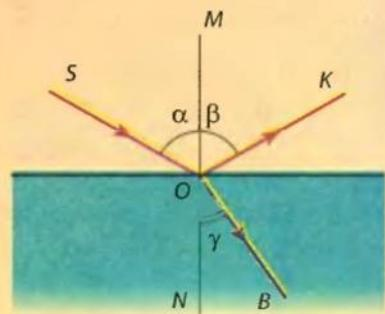
**Рис. 3.35.** Наблюдение преломления света с помощью оптической шайбы.  $\alpha$  — угол падения,  $\beta$  — угол отражения,  $\gamma$  — угол преломления светового пучка
