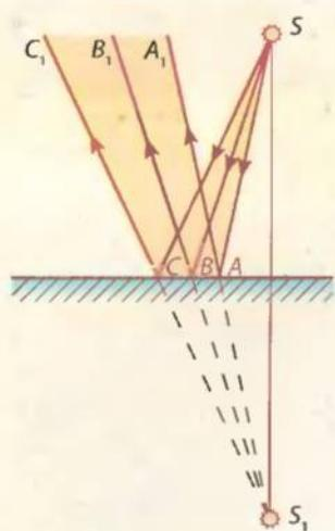
Рис. 3.24. Получение изображения точечного источника света  $S$  в плоском зеркале
