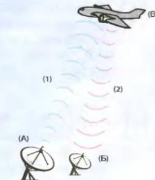
Рис. 1 — Принцип действия радара. А — передатчик; Б — приемник; В — объект (самолет); (1) — излучаемая волна; (2) — отраженная волна. В современных радарах передатчик и приемник, как правило, совмещаются
