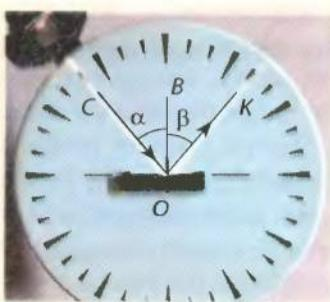
**Рис. 3.21.** Установление законов отражения света с помощью оптической шайбы
