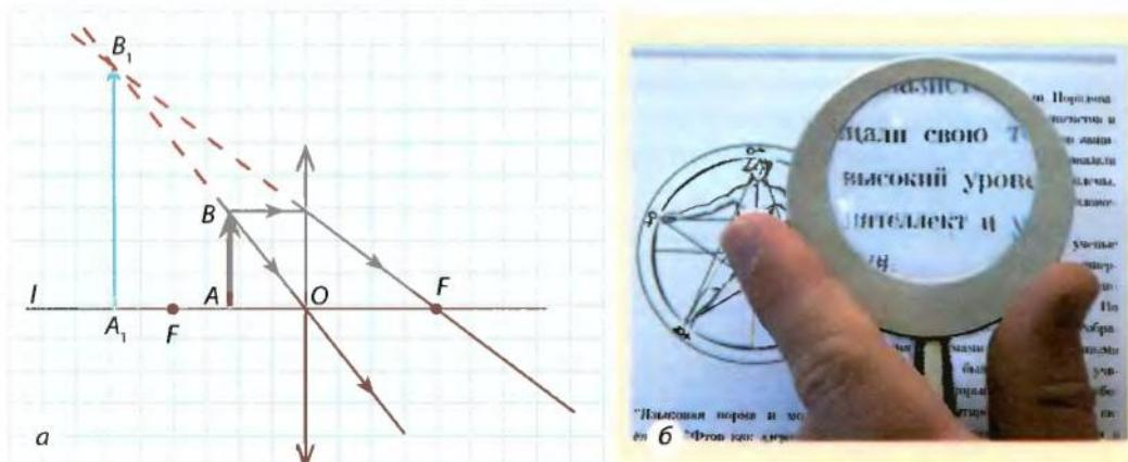
**Рис. 3.63.** а — построение изображения  $A_1B_1$ , предмета в собирающей линзе: предмет  $AB$  расположен между линзой и ее фокусом; б — с помощью лупы можно получить увеличенное изображение предмета и рассмотреть его подробнее
