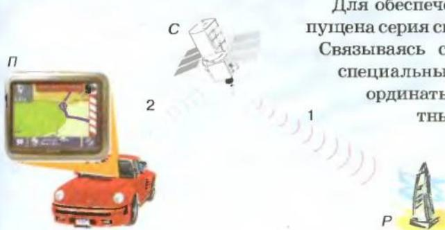
Рис. 4 — Схема работы системы GPS. С — спутник; Р — репер; П — пользователь прибора GPS. (1) — радиосигнал для связи с репером; (2) — радиообмен с пользователем
