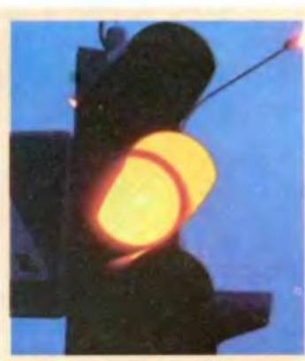
**Рис. 3.4.** Сигналы современных светофоров хорошо видны даже тогда, когда солнце светит ярко. В таких светофорах лампы накаливания заменены светодиодами
