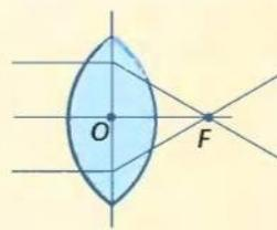
**Рис. 3.58.** Чем меньше радиусы сферических поверхностей, ограничивающих линзу, тем сильнее эта линза преломляет свет, следовательно, тем меньше ее фокусное расстояние  $F$
