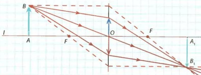
**Рис. 3.65.** Построение изображения  $A_1B_1$  предмета в случае, когда предмет  $AB$  значительно больше линзы
