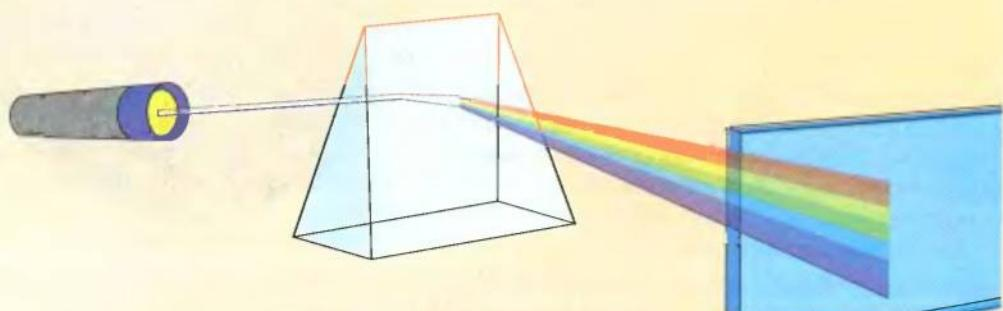
**Рис. 3.46.** Разложение белого света в спектр при прохождении сквозь стеклянную призму. Сильнее всего преломляются фиолетовые лучи, слабее всего — красные
