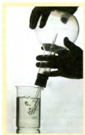
**Рис. 2.30.** При нагревании воздух в колбе расширяется и часть его выходит из колбы — это видно по пузырькам воздуха, выходящим из трубы
