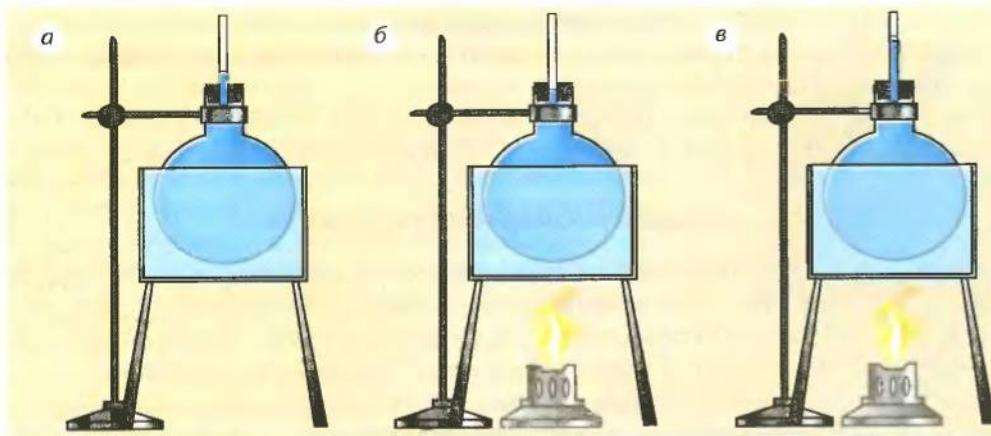
**Рис. 2.31.** Опыт, демонстрирующий, что при нагревании жидкость (как твердые тела и газы) расширяется: а — закрытая пробкой колба с жидкостью в трубке; б — в первый момент нагревания уровень жидкости немного снижается; в — при дальнейшем нагревании уровень жидкости значительно повышается
