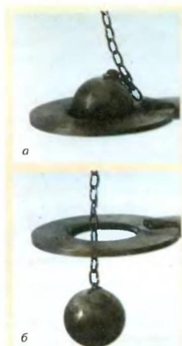
**Рис. 2.32.** Опыт, иллюстрирующий тепловое расширение твердых тел: а — в нагретом состоянии шарик не проходит сквозь кольцо; б — после охлаждения шарик проходит сквозь кольцо
