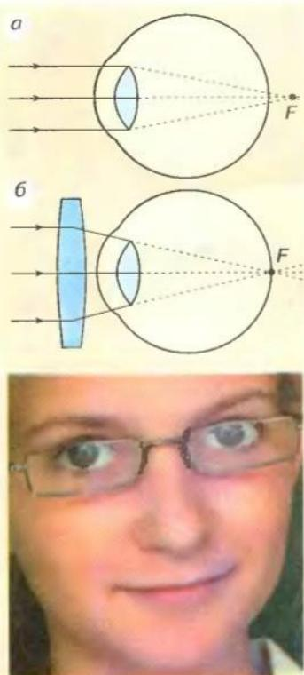
**Рис. 3.70.** В случае дальнозоркости в спокойном состоянии глаза фокус  $F$  оптической системы глаза расположен за сетчаткой (а). Изображение удаленных предметов на сетчатке получается нечетким. Для коррекции дальнозоркости используют собирающие линзы (б)
