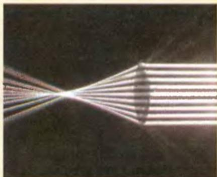
Рис. 3.53. Параллельные лучи, преломляясь в собирающей линзе, пересекаются в одной точке (справа — условное изображение собирающей линзы)
