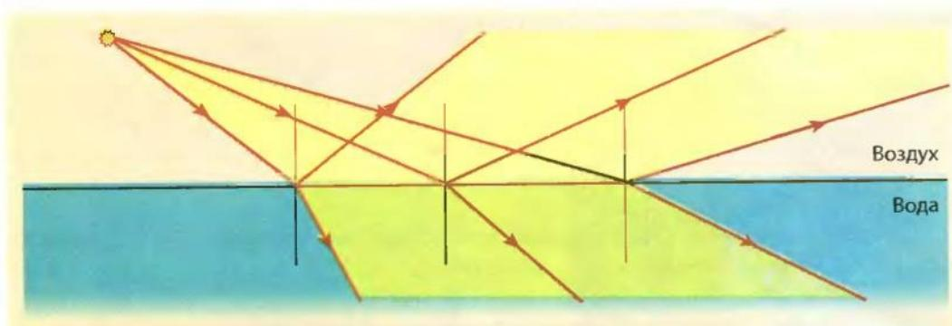
**Рис. 3.33.** Схема опыта по демонстрации преломления света. Переходя из воздуха в воду, луч света изменяет свое направление, смещаясь к перпендикуляру, восставленному в точке падения луча
