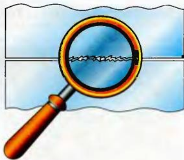
Рис. 53. Трение возникает вследствие наличия неровностей на поверхностях
