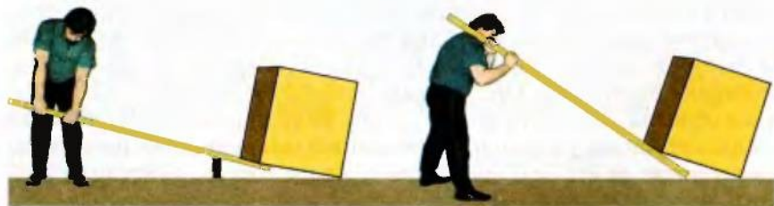
Рис. 59. Поднимание груза при помощи рычага
