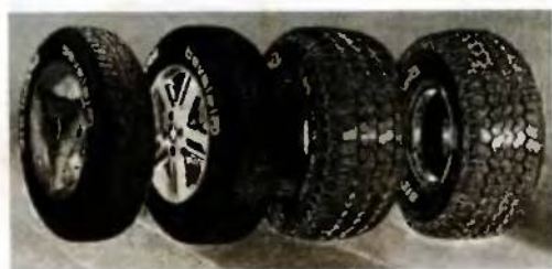
Рис. 54. Для увеличения силы трения на поверхности скатов (шин) наносят рисунок – протектор
