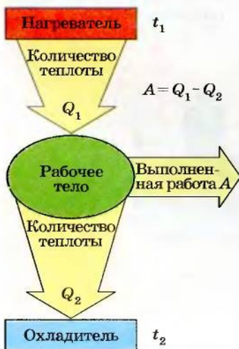
Рис. 151. Принцип действия тепловой машины
