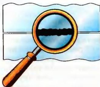
Рис. 56. Трение уменьшается, если между трущимися поверхностями поместить смазку
