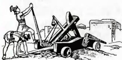
Рис. 62. Рычаг использовали в древних военных машинах
