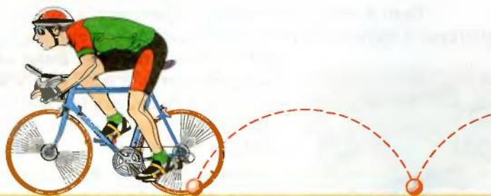
Рис. 11. Такую траекторию движения точки колеса видит наблюдатель, стоящий у дороги
