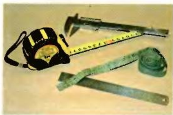
Рис. 12. Для измерения линейных размеров используют линейки, рулетки, измерительные ленты и другие приборы
