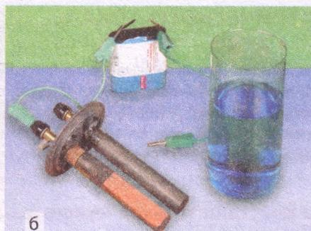
**Рис. 6.2.** Опыт, демонстрирующий химическое действие электрического тока: если некоторое время пропускать ток через водный раствор купрум сульфата (а), на одном из электродов образуется тонкий слой меди (б)
