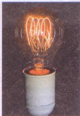
Рис. 17.4. Нагревательный элемент электрической лампы накаливания изготавливают из вольфрама, температура плавления которого 3387°C. Нагреваясь до температуры выше 2000°C, тонкая вольфрамовая нить начинает ярко светиться
