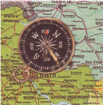
**Рис. 24.2.** Стрелка компаса — постоянный магнит, один полюс которого указывает на север, а второй — на юг
