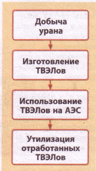
Рис. 36.5. Схема ядерного цикла
