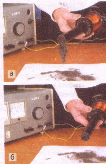
Рис. 27.3. После замыкания цепи железные опилки притягиваются к сердечнику (а); после размыкания — осыпаются (б)
