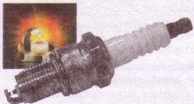
Рис. 22.3. Электрическое напряжение между электродами свечи зажигания составляет 12–15 тыс. вольт
