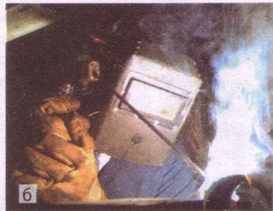
Рис. 22.10. Применение дугового газового разряда для плавки (а) и сварки (б) металлов
