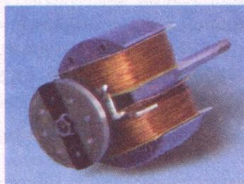
Рис. 28.5. Ротор двигателя, содержащий одну обмотку
