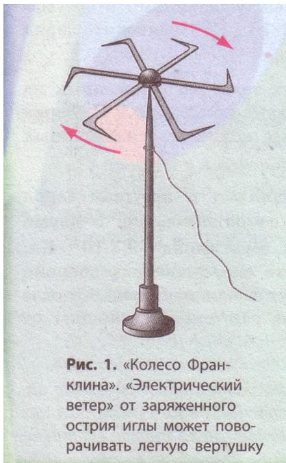
**Рис. 1.** «Колесо Франклина». «Электрический ветер» от заряженного острия иглы может поворачивать легкую вертушку
