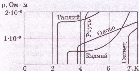
**Рис. 18.5.** Графики изменения удельного сопротивления некоторых металлов при температурах, близких к абсолютному нулю. С приближением к нулевой отметке удельное сопротивление этих металлов скачком падает до нуля — металл переходит в сверхпроводящее состояние
