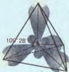
Рис. 33. Тетраэдрическое строение молекулы метана
