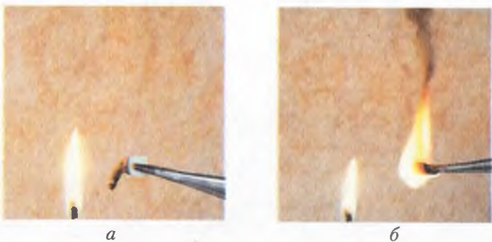
Рис. 62. Горение поливинилхлорида (а) и полистирена (б) вне пламени
