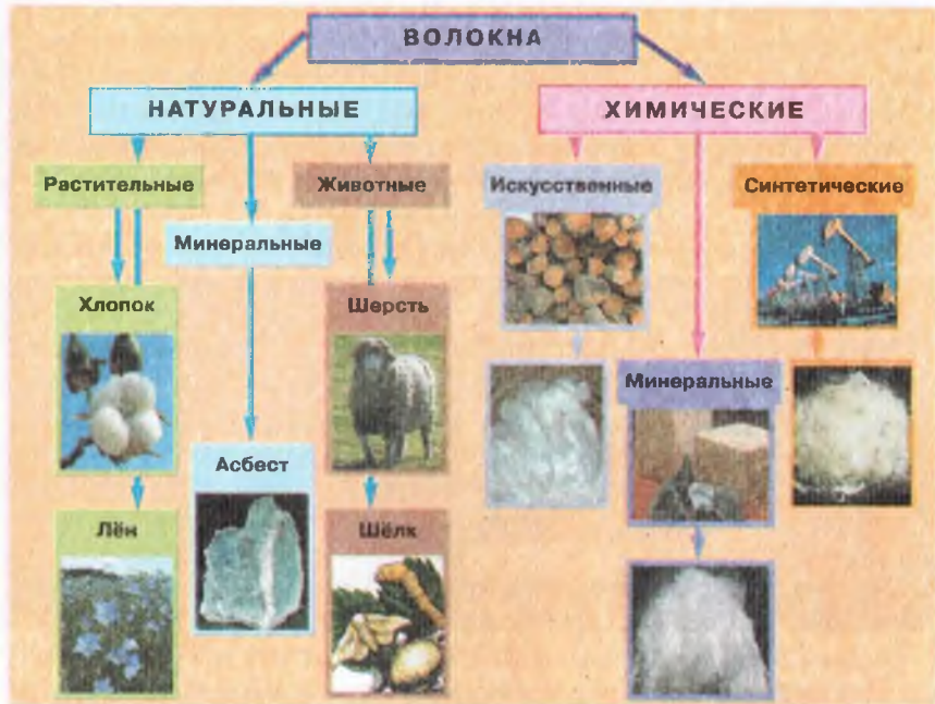
Рис. 72. Схема классификации текстильных волокон
