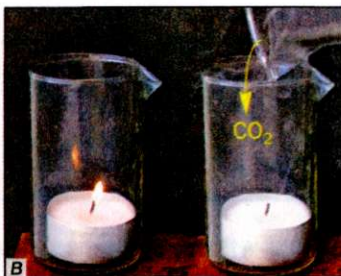
Рис. 63. Гашение пламени: а — водой; б — песком; в — угле- кислым газом
