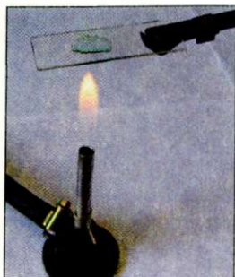
Рис. 17. Выпаривание жидкости на предметном стекле
