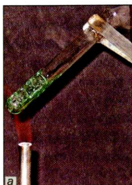
Рис. 15. Нагревание жидкости в пробирке: а — закрепленной в пробиркодержателе; б — закрепленной в штативе
