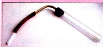
Рис. 59. Прибор для получения газа
