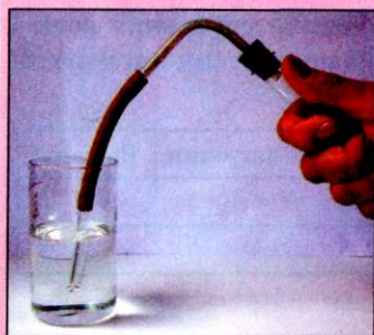
Рис. 60. Проверка прибора на герметичность
