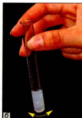
Рис. 13. Перемешивание жидкости: а — стеклянной палочкой; б — встряхиванием
