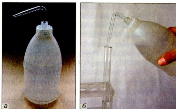
Рис. 7. Промывалка (а) и ее использование (б)
