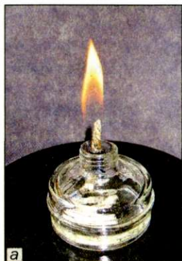
Рис. 10. Нагревательные приборы: а — спиртовка; б — гашение пламени колпачком; в — газовая горелка
