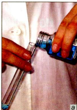
Рис. 14. Переливание жидкости: а — из баночки в пробирку; б — с помощью стеклянной палочки; в — из одной пробирки в другую
