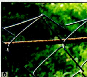
Рис. 69. Коррозия железа: а — бочка, которую «съела» ржавчина; б — ржавая проволока, на которой закреп- лена оцинкованная железная сетка
