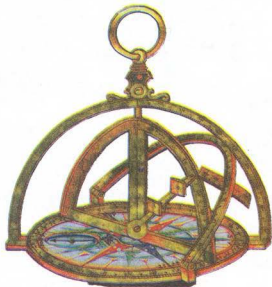
■ Морская полусфера – прибор, позволявший точно держать избранный курс корабля
