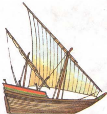
■ Каравелла – двух- или трехмачтовый корабль с небольшим водоизмещением
